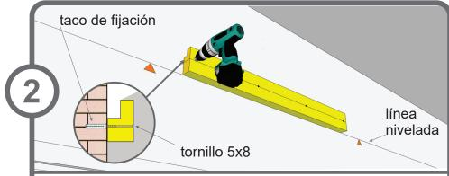
Marque una línea nivelada para indicar la posición a la que montará la garganta, luego hágala coincidir con la misma. Para montarla en mampostería podrá marcar así donde realizar los agujeros para los tacos (diam8), para otro tipo de tabiques utilice la fijación correspondiente. Los tornillos recomendados para todos los casos son de 5 x 80.
