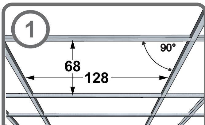
Determine la posición donde desea colocar la tapa de inspección TIOG. La luz interna de la estructura debe tener **128cm x 68 cm**, asegurando que los **4 ángulos tengan 90°**.
