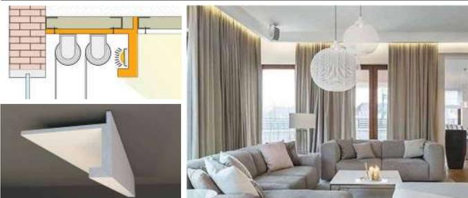
Cortinero en caso de nivel del cielorraso por encima de los dos barrales o rollos de cortina. APTO PARA MAMPOSTERÍA. Se puede colocar a cualquier altura respecto del cielorraso, prolongando con placa de yeso vertical hasta llegar al mismo. Dos barrales o rollos de cortina. Apto Blackout.
